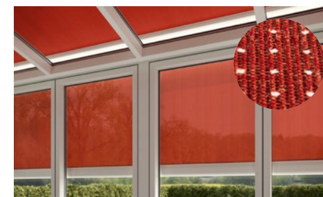
transolair Sonnenschutz mit Durchblick. Das sunvas Gewebe mit spezieller Lochtechnik steht für angenehme Transparenz sowie gute Licht- und Luftdurchlässigkeit. Es gewährleistet einen Luftaustausch zwischen Tuch und Glas, Stauwärme wird reduziert.
